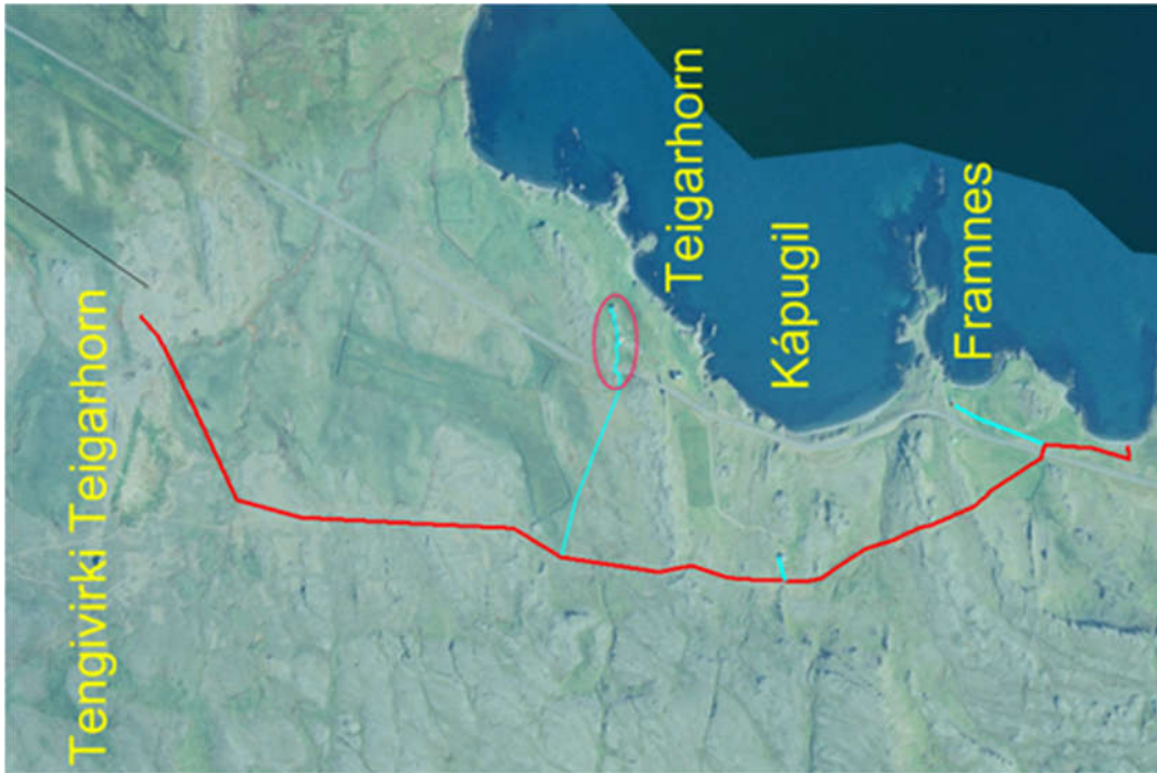
Mynd 1 Loftmynd sem sýnir legu ljósleiðara í sunnanverðum Berufirði sem rauðar- og bláar línur.
